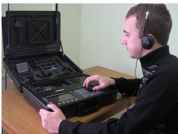
*Мониторинг радиоэлектронной обстановки с помощью спектрального коррелятора*
