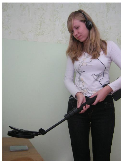
*Поиск закладных устройств с помощью нелинейного локатора*
