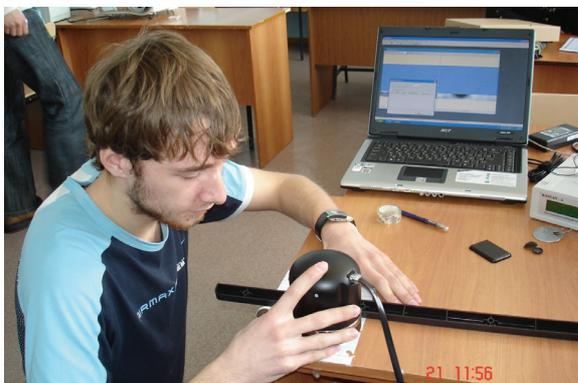
*Поиск закладных устройств с помощью голографического радиолокатора*
